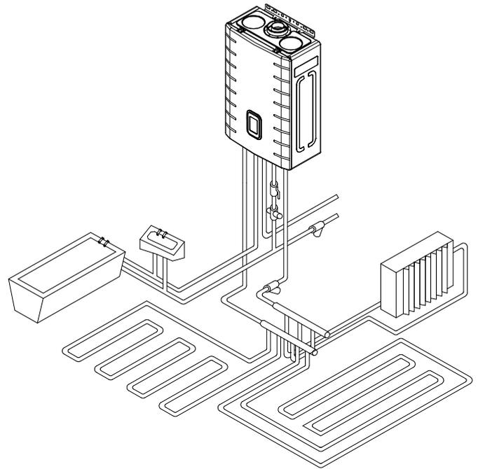
Рисунок 8. Пример монтажа системы отопления и ГВС.
